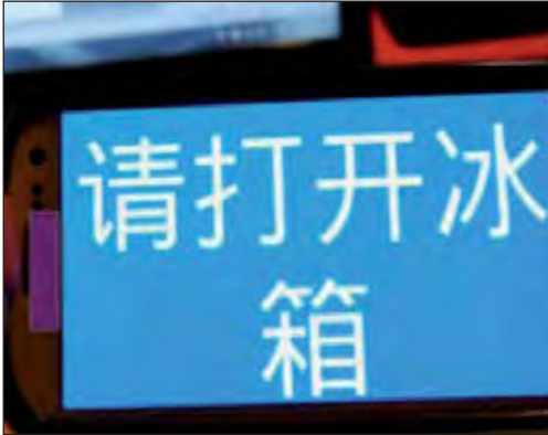
Foto 3.4.13. Il testo del messaggio registrato è aumentato di dimensione sul touchscreen per facilitarne la lettura.
